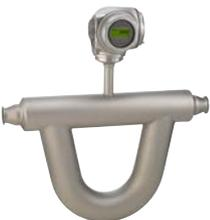
요구 사항이 매우 까다로운 어플리케이션에서도 질량 유량과 밀도를 매우 정확하게 측정합니다. "멀티 주파수 기술" (MFT)로 기체를 포함하고 있는 액체에 대해서도 뛰어난 성능을 발휘합니다. SIP/SIP 세척 후 즉시 사용할 수 있습니다. 보호 정도가 매우 높습니다(IP69K). 전후단 직관부가 없습니다.
