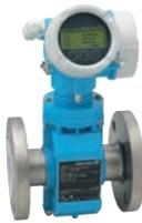
부식성 액체와 고온 매질용 루프 전력 기기(4~20 mA)입니다. 유체에 닿는 부품은 화학 물질에 강한 재질로 제조되었습니다. 유지보수가 필요 없으며, 구동부가 없어 압력이 손실되지 않습니다.
