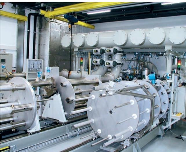
소급 가능하고 주기적으로 교정하는 기준 미터 3개(노즐, 회전 피스톤 및 터빈)로 구성된 어레이는 ±0.3%의 측정 불확도로 고객 유량계를 교정합니다. 특별 기후 통제 시스템은 교정 체임버 내 공기를 온도24 °C, 습도 40%로 상시 유지합니다.
