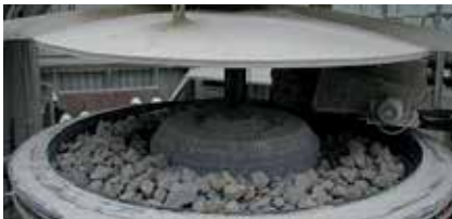
원격 설치된 헤드 트랜스미터를 통해 고온의 시멘트 생산공정 온도 측정
